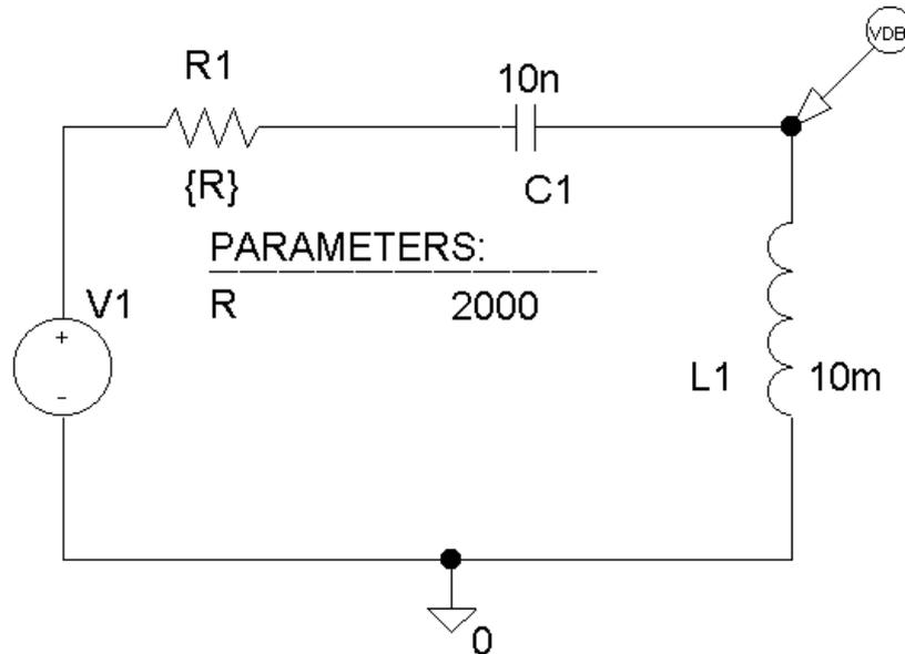
Il circuito presenta gli stessi componenti del circuito precedente, solo che questa volta, l' uscita del circuito è stata presa sull' induttanza. Il marker VdB di conseguenza va posizionato sull' induttanza. Seguendo gli stessi procedimenti effettuati precedentemente, sia per l' impostazione dei valori dei componenti, sia per i valori di simulazione, il circuito va lanciato in simulazione. Di seguito è riportata la risposta fornita dal Probe:
