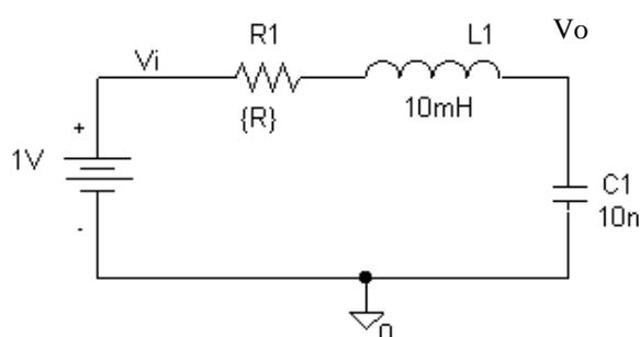
In laboratorio è stata effettuata anche un'esperienza pratica inerente il circuito RLC. Dopo aver montato il circuito RLC e dopo aver attaccato l'oscilloscopio alla sua uscita, è stata analizzata la forma d'onda d'uscita del circuito (in funzione del tempo, si intende), al variare del valore ohmico della resistenza R, e quindi dello smorzamento. In particolare si è potuto vedere come al di sotto del valore della resistenza critica,
