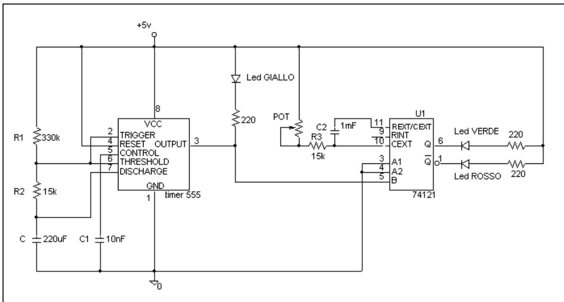
In questa esperienza abbiamo costruito il circuito rappresentato in figura, che simula, mediante l'accensione di tre LED, il funzionamento di un impianto semaforico.
