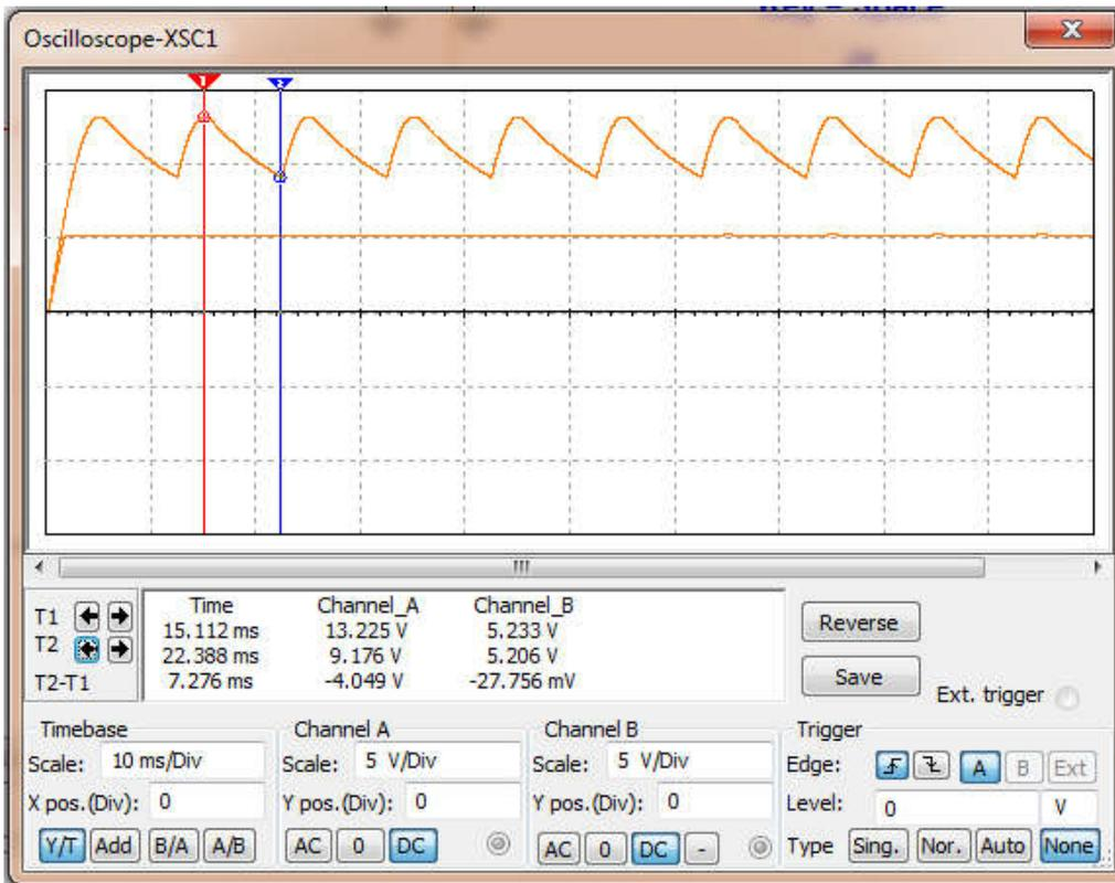
Con la chiusura dell'interruttore J1, il carico utilizzatore è solo  $R_3=40\Omega$  e quindi l'alimentatore deve fornire più corrente al carico. Si osserva nella successiva figura, ad occhio, una impercettibile ondulazione peraltro non riscontrabile dall'esame dei valori massimo e minimo di cursori 1 e 2 relativamente al canale B. Lo stabilizzatore sta lavorando assai bene.
