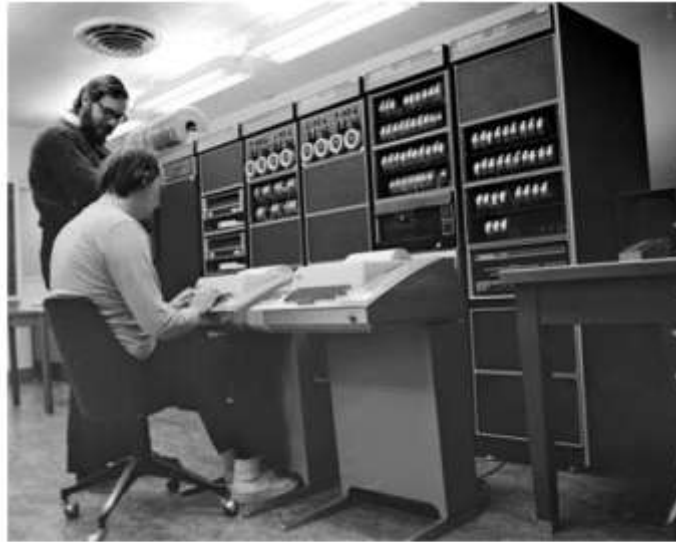
Dennis Ritchie (in piedi) e Ken Thompson iniziano il porting di UNIX sul PDP-11, tramite due TeleType ASR-33
