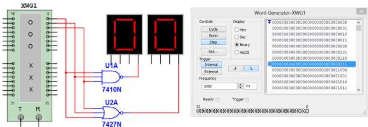
In questo secondo caso, il programma Multisim consente di pilotare il NAND e il NOR con i tre bit meno significativi del Word Generator. Quest'ultimo è impostato per generare tutte le sequenze a 31 bit. In particolare si sfruttano solo i 3 bit meno significativi che ci danno le configurazioni da 000 a 111 come si vede a destra.
