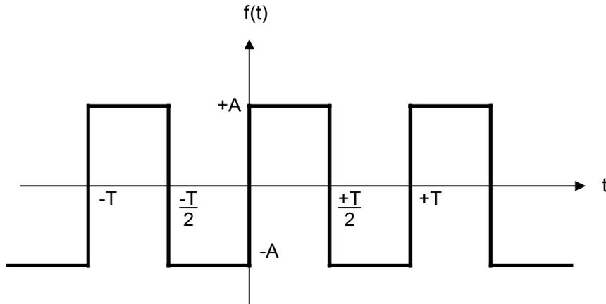
Fig.1. - Funzione ad onda quadra bipolare.
