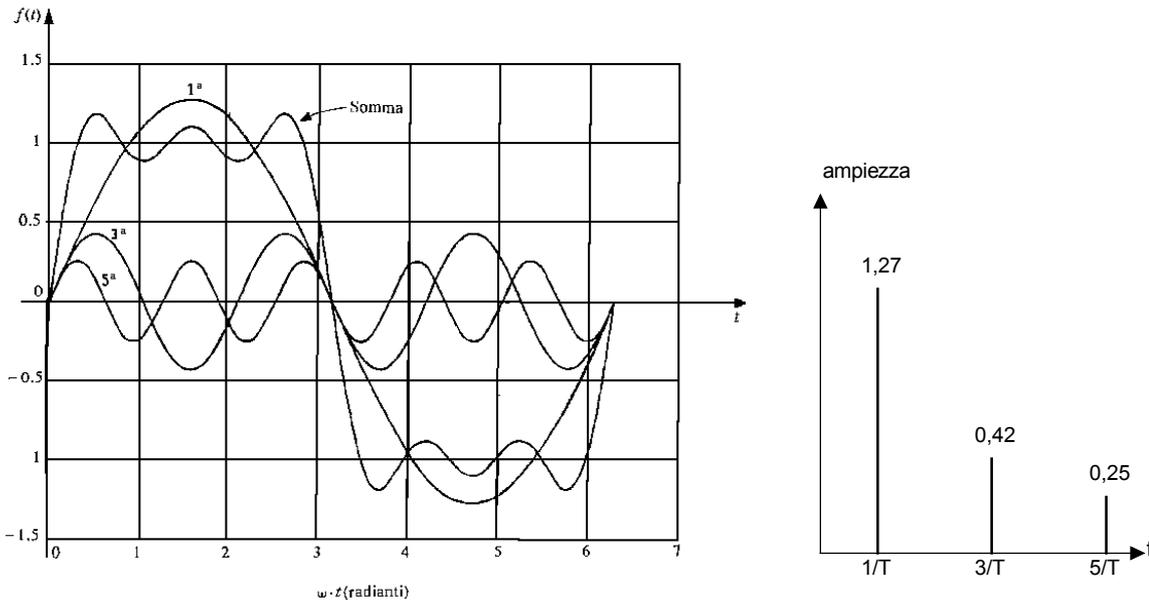
Fig.2. - Onda quadra: prime tre componenti armoniche della serie di Fourier e relativo spettro.
