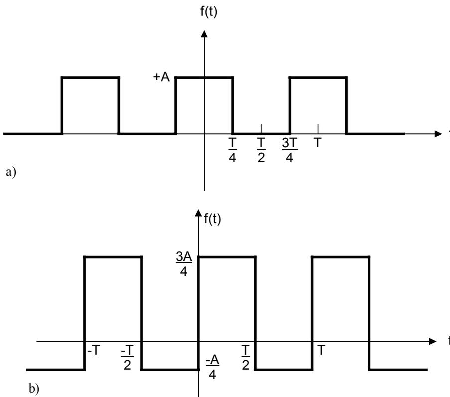
Fig.3. - a) Onda quadra unipolare; b) onda quadra bipolare.
