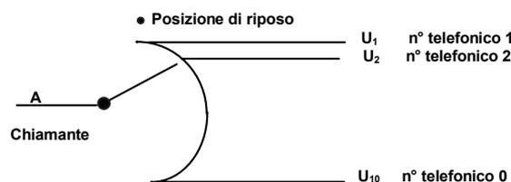
Fig. 6 Collegamento di un utente A con 10 utenti U.
