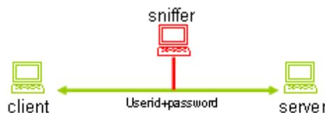
Fig.9. – Schema di principio dello sniffing.
