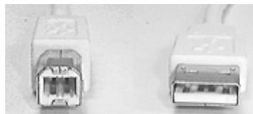
**Fig.13. – Terminali del cavo USB. A sinistra si mostra il terminale che si applica al periferico, a destra quello che va al PC.**
