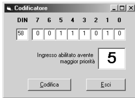
**Fig.43. – Schermata del programma supponendo di aver attivato gli ingressi 5, 4, 3, 1. Quello con maggior priorità è l'ingresso 5. Dall'interfaccia Centronics si attiva il codice binario a 7 bit 109 che comanda il display a sette segmenti in modo da visualizzare il numero 5.**
