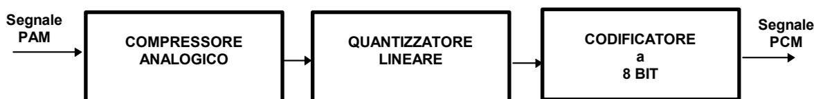
Fig.16a) Quantizzatore non lineare analogico
