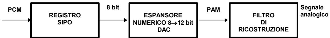
Fig.20b) Schema a blocchi del ricevitore PCM con espansore numerico.
