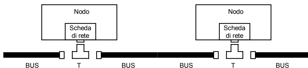
Fig.9. - Collegamento del BUS di rete a due nodi utilizzando adattatore BNC a T.
