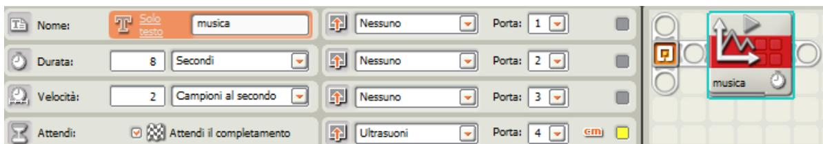
Aggiungiamo un loop con controllo a durata per 8 secondi all’interno del quale inseriamo una scelta condizionata dal sensore ad ultrasuoni per una distanza maggiore di 40cm.
