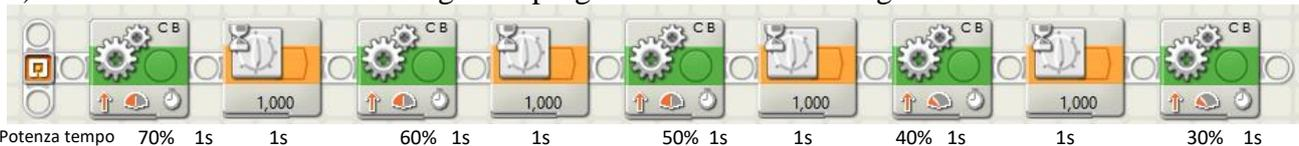
Sono stati inseriti blocchi di pausa di 1s per consentire di segnare con la matita la posizione del robot dopo lo spazio percorso di ciascun blocco motore. Compilare la tabella e disegnare il grafico dello spazio totale percorso in funzione del tempo.
