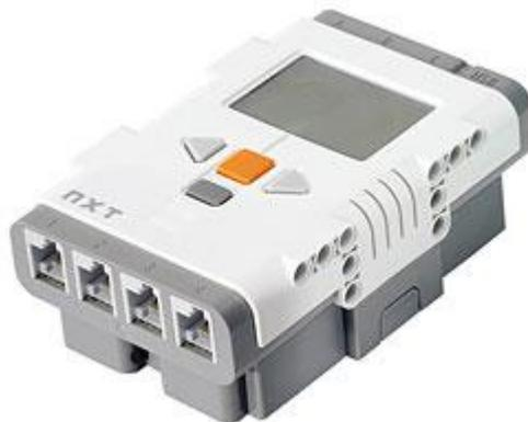
Il cervello è un ARM7: processore a 32 bit prodotto dalla ditta Atmel dotata di:
