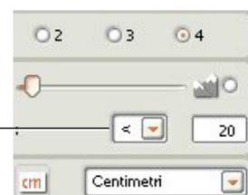
È necessario un secondo Blocco motore con selezionato il simbolo Stop invece di una freccia direzionale. In seguito, il robot si fermerà per 2 secondi prima di utilizzare un terzo Blocco motore per terminare l’attività.
