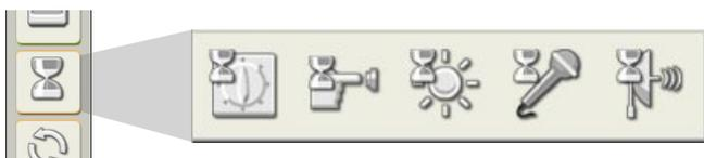
L'unico blocco della Barra delle funzioni comuni a contenere un sottomenu di 5 blocchi. Quando si costruisce il modello standard, la guida indica all'utente di inserire i sensori in una porta predefinita. Tali porte sono fisse nel software NXT e devono essere cambiate dall'utente, se questi lo desidera.
