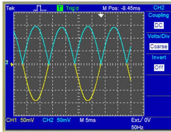
Al segnale sinusoidale di ingresso di colore giallo si notano, sovrapposte, le semionde positive in celeste del segnale di uscita del raddrizzatore.
