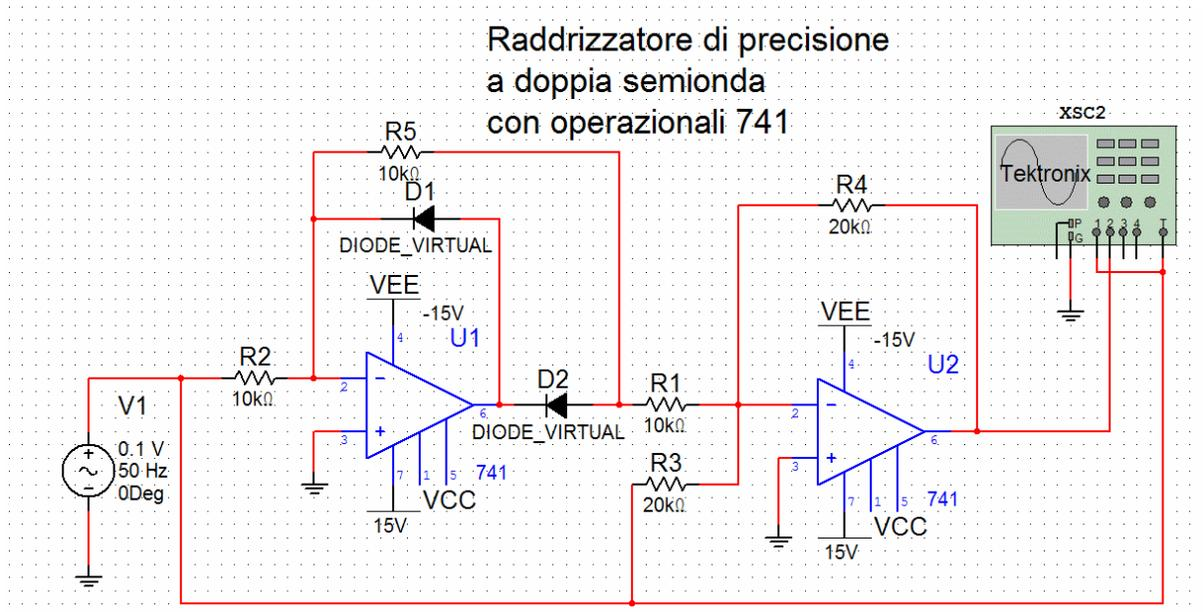
Il circuito fa uso di due amplificatori operazionali U1 e U2 del tipo 741.
